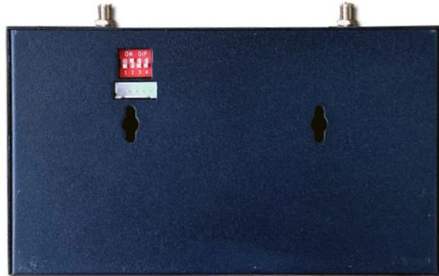
红色拨码开关中的 2 号是内置电池开关，当切换到 ON 的一端为使能内部锂电池。其他 1-3-4 号请拨 ON 的另一端，若更新这 1-3-4 拨码开关的功能时会另行介绍。内置锂电池的目的时为了方便测试实验，由于 EG59-TFT 的功耗大，内置电池只能持续 6 个小时左右，如需要常年使用时，可通过配套电源适配器来供电，建议长期供电时通过 2 号拨码开关切断内部电池电路，以防止电池被过冲导致损坏。
