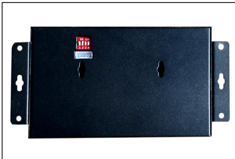
备注：红色拨码开关中的 2 号是内置电池开关，当切换到 ON 的一端为启用内部锂电池。其他 1-3-4 号请拨 ON 的另一端，若更新这 1-3-4 拨码开关的功能时会另行介绍。内置锂电池的目的时为了方便测试实验，但由于 ET59-TFT 的功耗大，内置电池只能持续 6 个小时左右，如需要常年使用时，需要通过我们提供的电源适配器外部电源供电，为了防止电池被过冲导致损坏，建议长期供电时通过 2 号拨码开关切断内部电池电路。
