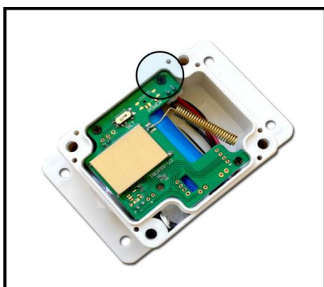
拧开3个固定电路板螺丝
