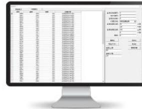
多路温度采集器无线传输给RE59-P-USB接收器，并直接上传给电脑温度记录软件，这种测温方式简单直接，但随着无线测温点与RE59-P-USB接收器之间距离越远、隔墙越多，信号衰减就越大，稳定性也会下降，且电脑关机就停着记录温度，也无法实现手机、异地电脑观测，所以此方案适合测温点数量不多、测温点相对集中或临时性温度实验。
