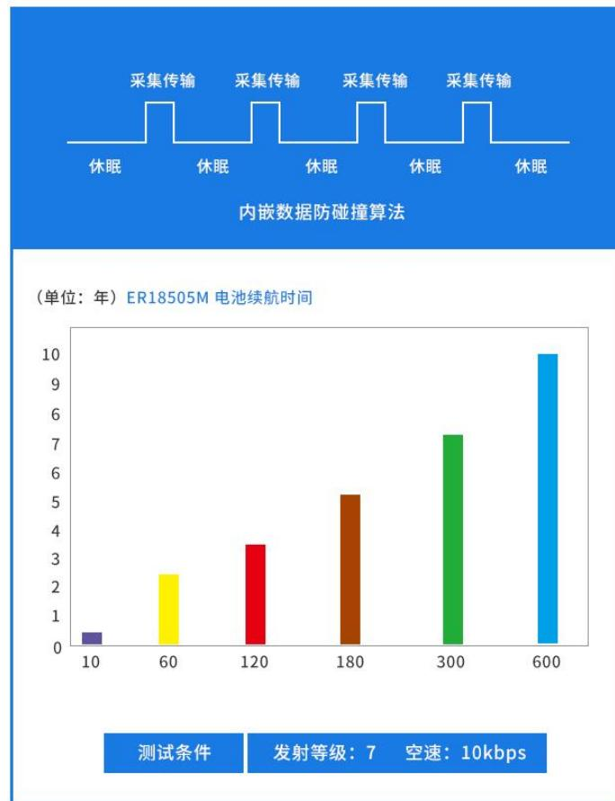
**【应用场景一】**只需传输 10 米左右，但要求温度采样率高，那么可将发射功率等级设置为 1，无线上传时间为 10S，这样电池依然可耐用 1 年左右。
