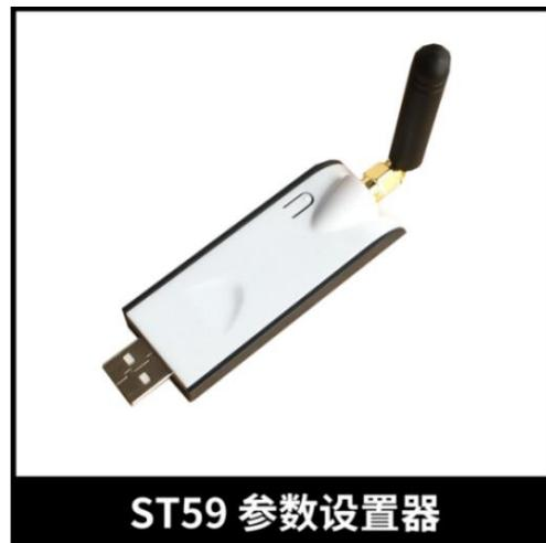
第一，解压 ST-RE59-59USB 驱动文件，双击 CH341SER，点击安装即可完成驱动的安装。安装好驱动后将 ST59 与电脑的 USB 端口连接，通过电脑端设备管理器可以查到到虚拟串口设备，即代表安装成功，注意不同的 USB 端口，对应的 COM 口号不同
