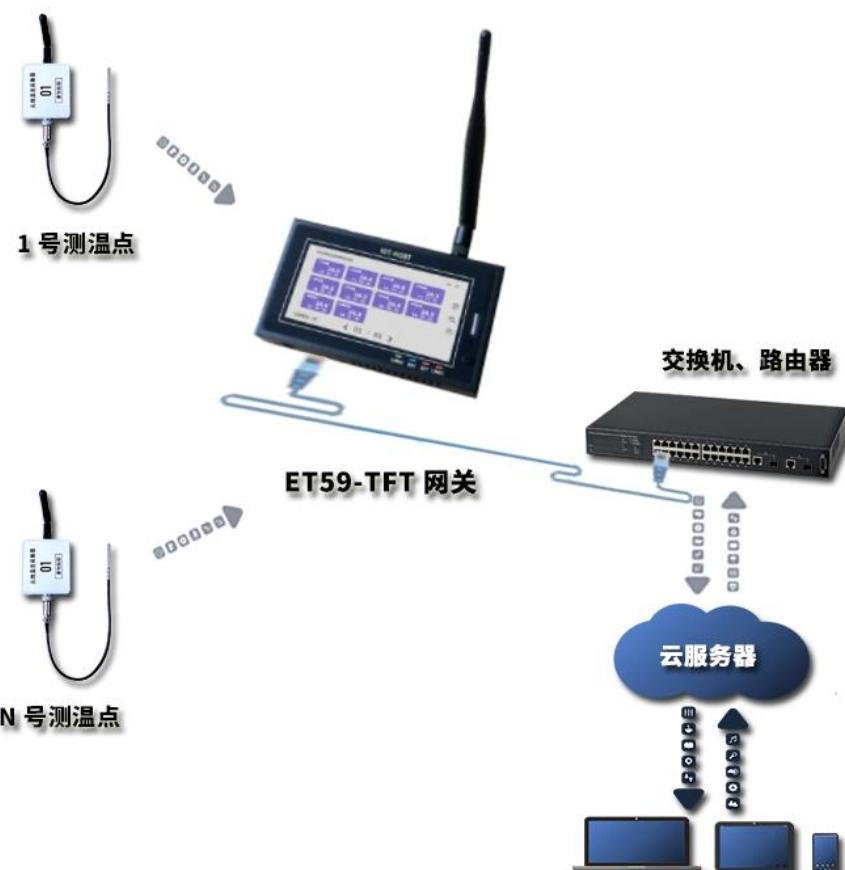
以太网作为传统的互联网接入技术广泛应用于各行各业，相比GPRS和WIFI，以太网的稳定性更佳，无线通讯技术解决了分散布线麻烦的问题，与以太网技术相结合，实现高性能集散数据采集方案。
