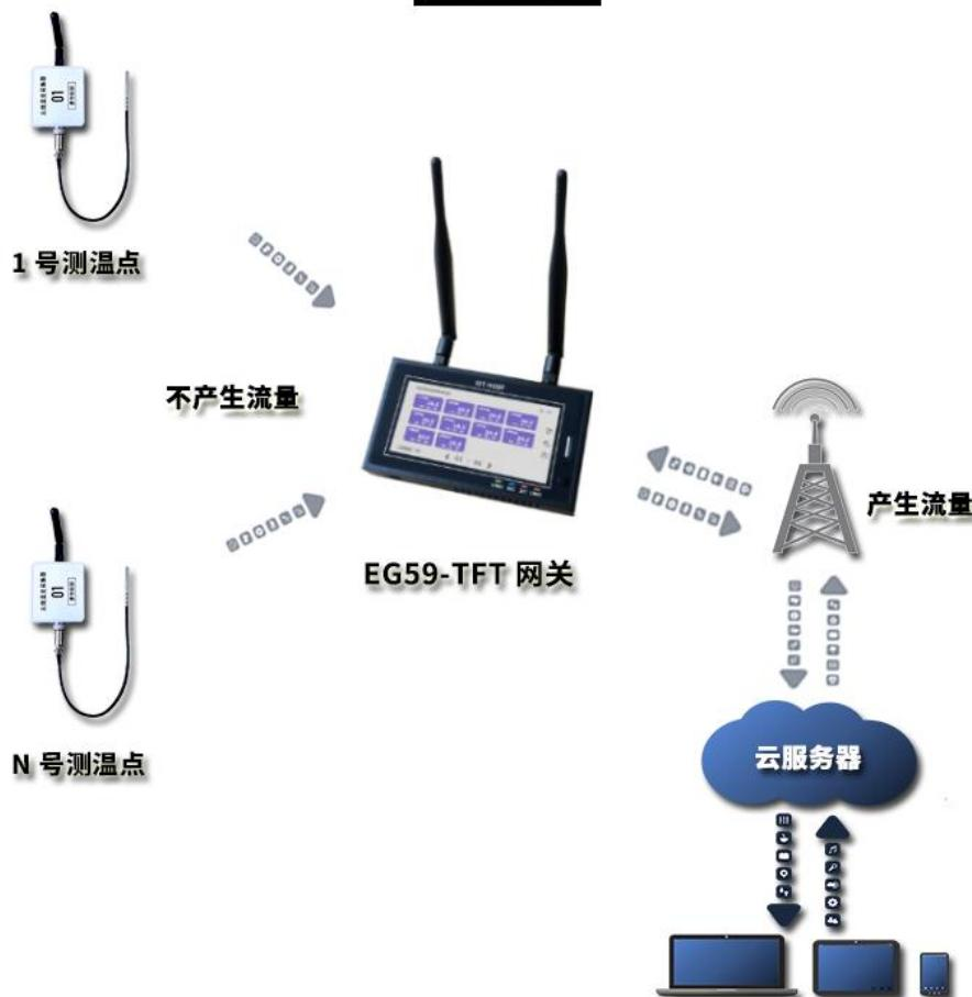
GPRS 的便利性毋庸置疑，但其功耗是 433MHZ 无线的几十倍。此方案通过 433MHZ 低功耗无线技术与 GPRS 广域通讯技术相结合，既实现测温点数多年不换电池，又使流量卡的使用数量直接减少 90% 以上。
