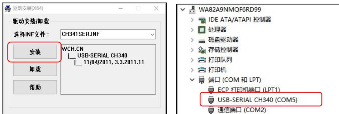
安装好驱动后将 ST59 与电脑的 USB 端口连接，通过电脑端设备管理器可以查到到虚拟串口设备，即代表安装成功，注意不同的 USB 端口，对应的 COM 口号不同
