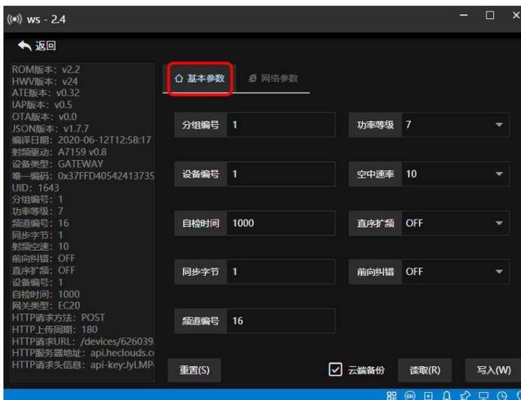
**【射频参数】**WG/EG59-TFT 射频参数要和同组的无线温度采集器一致才能建立通讯，是无线温度传感器和网关之间配对的前提条件，其中射频参数的使用要领说明可参考文档《如何通过参数设置来减少干扰》。
