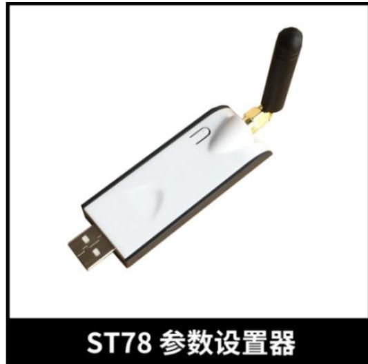
第一，解压 ST-RE59-78USB 驱动文件，双击 CH341SER，点击安装即可完成驱动的安装。安装好驱动后将 ST78 与电脑的 USB 端口连接，通过电脑端设备管理器可以查到到虚拟串口设备，即代表安装成功，注意不同的 USB 端口，对应的 COM 口号不同
