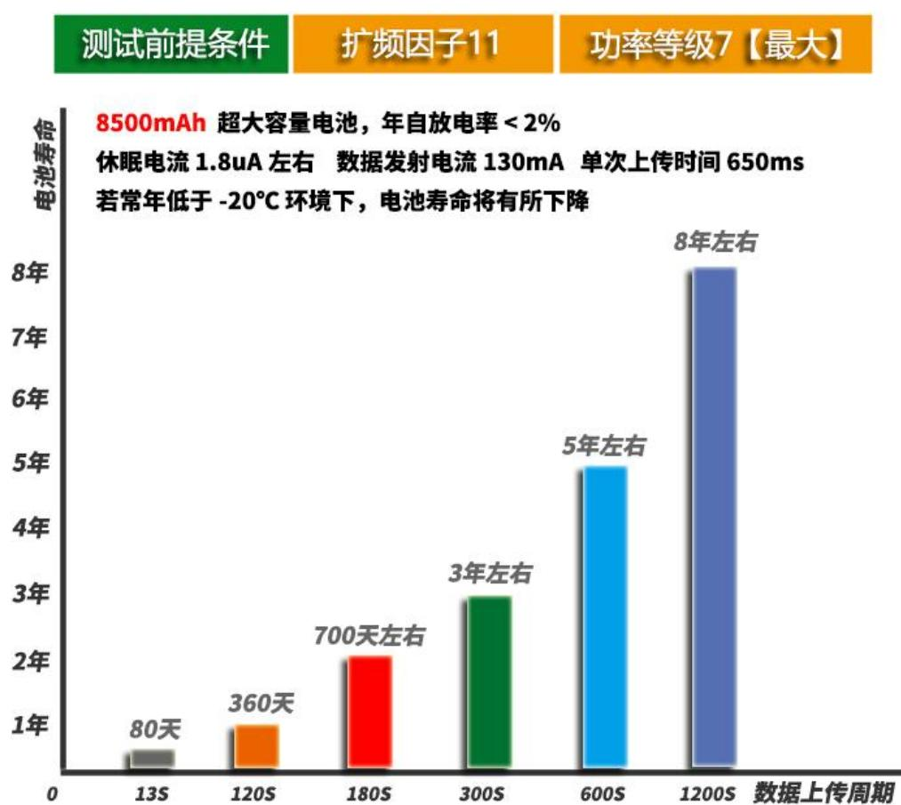
工业现场环境往往比较复杂，如果设计出充电模式，可能当要充电时，充电接口已经损失，且待测温设备较分散，所以只有无线传输距离远，电池又可使用多年，无线测温技术才有真正的实用价值。以下是 NT78-LI-D 无线温度采集器的工作原理与功耗数据分析。
