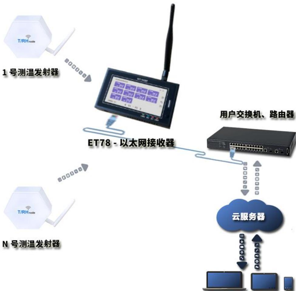
以太网作为传统的互联网接入技术广泛应用于各行各业，相比GPRS和WIFI，以太网的稳定性更佳，LORA无线技术解决了分散布线麻烦的问题，但LORA无法直接接入互联网，与以太网技术相结合，实现高性能集散数据采集方案。
