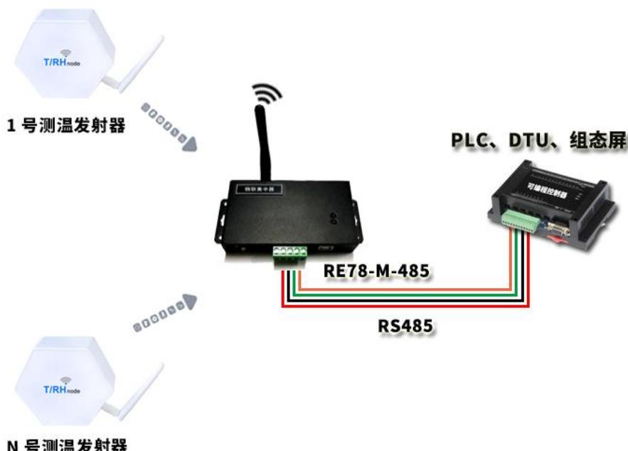
RE78-M-485集中器与用户设备之间为RS-485总线接口，通过MODBUS协议指令读取缓存数据，并进行数据二次开发。其中用户设备可以是电脑、PLC、组态屏、DTU、串口服务器等。
