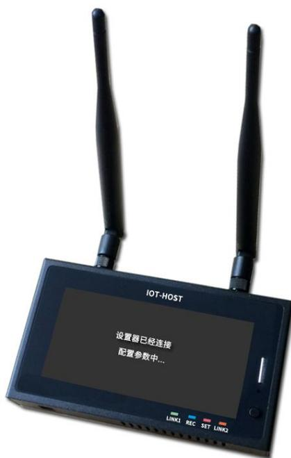
先关机，然后长按银色设置按钮后开机，直到出现处于设置状态界面后方可松开银色按钮，进入设置模式后即可进行参数修改，详细网关设置方法参考一下视频演示连接：
