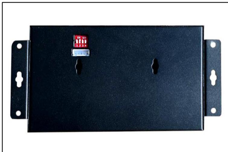
备注：红色拨码开关中的 2 号是内置电池开关，当切换到 ON 的一端为使能内部锂电池。其他 1-3-4 号请拨 ON 的另一端，若更新这 1-3-4 拨码开关的功能时会另行介绍。内置锂电池的目的时为了方便测试实验，但由于 WT78-TFT 的功耗大，内置电池只能持续 6 个小时左右，如需要常年使用时，需要通过我们提供的电源适配器外部电源供电，为了防止电池被过冲导致损坏，建议长期供电时通过 2 号拨码开关切断内部电池电路。
