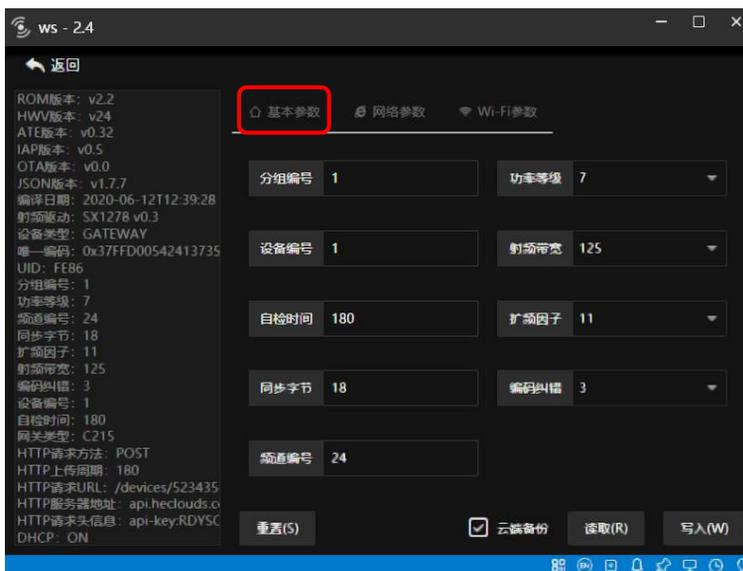
**【射频参数】** WT78-TFT 网关的射频参数要和对应同组的无线温度采集器一致方可建立通讯，也就是无线温度传感器和网关之间配对的前提条件就是射频参数，射频参数的使用要领，可参考文档《如何通过参数设置来减少干扰》。
